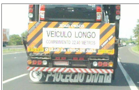
Excesso de informações junto à sinalização traseira, tornando ela desconforme.
